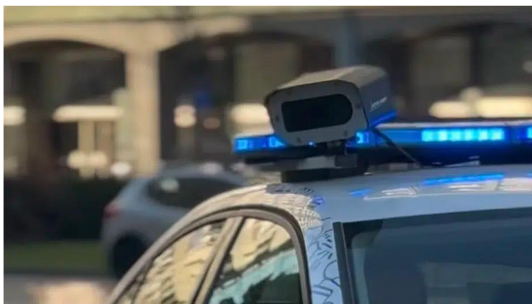
Fig. 91 Câmaras de fiscalização de estacionamento em veículos da Polícia Municipal
